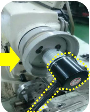
5. 滾軸鎖上螺絲並安裝定位器
