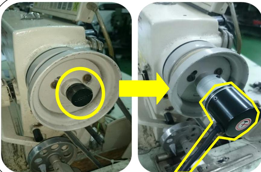
4. 滾軸鎖上螺絲並安裝定位器
