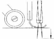
變速機的紅線對齊入力軸紅線後，上緊時規齒輪螺絲
