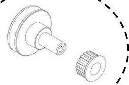
時規皮帶鬆緊固定螺絲，可依所需調整皮帶鬆緊
